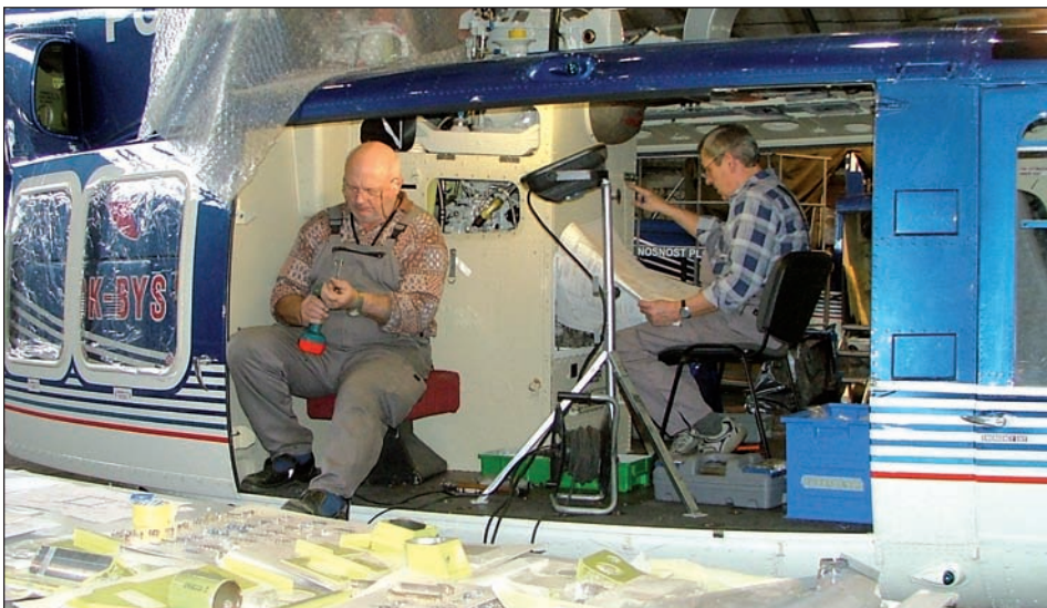
Technici Josef Kovář a Miroslav Matějka při zástavbě slaňovací hrazdy do vrtulníku Bell 412 EP
