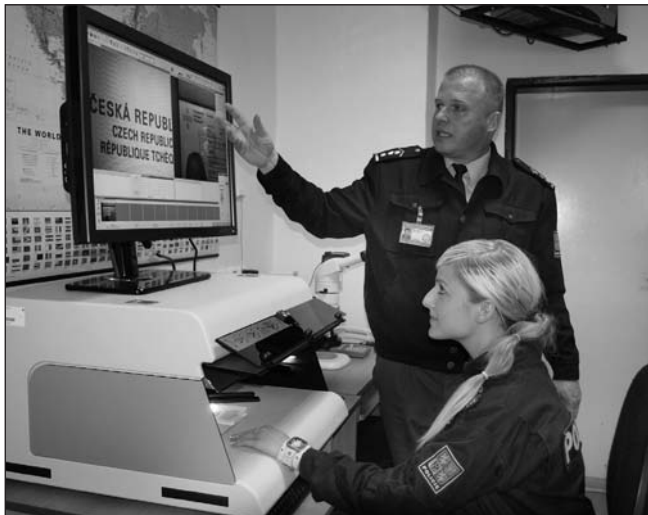
Videospektrální komparátor VSC 6000 pro zkoumání pasů, víz, průkazů a podezřelých dokumentů
