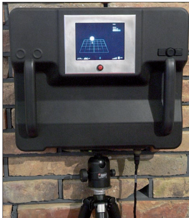
Radar ReTWIS od pardubické firmy Retia umí zjišťovat přítomnost lidí v budovách nebo v místnostech, jejich pozici a pohyby
