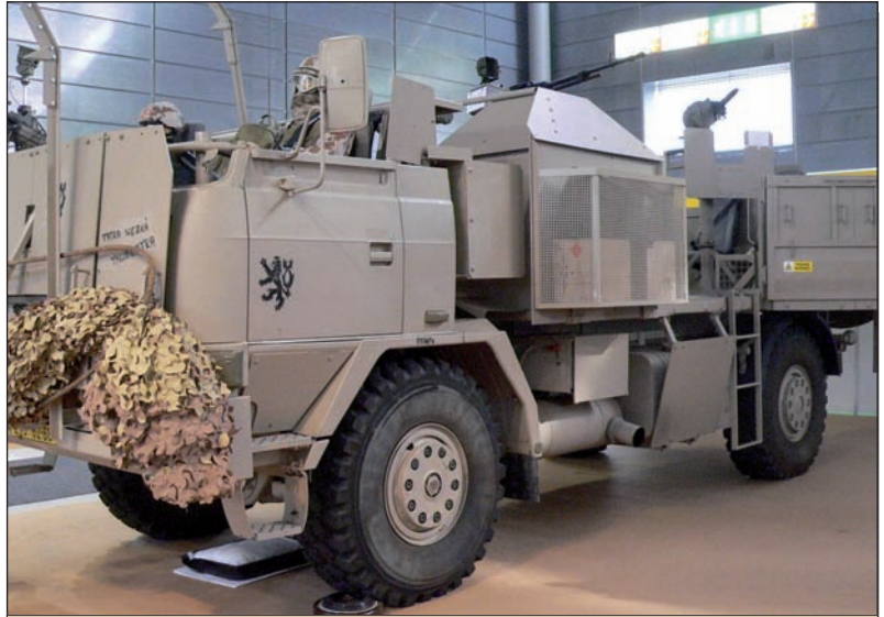
Tatra 815 4x4 v provedení jako mateřské vozidlo (mobilní základna) doprovodných konvojů na misích Armády ČR. Vozidlo je vyzbrojeno kulomety a 30mm automatickým granátometem.
