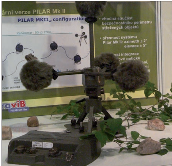
Ve stánku VOP 026 Šternberk byl k vidění systém PILAR Mk II k detekci směru přicházející střelby z ručních zbraní
